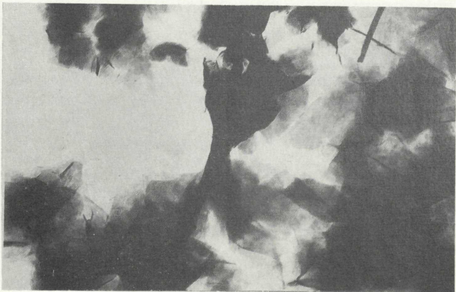
Obr. 25 Elektronová mikrofotografia montmorillonitu. Vzorka 205, vrt Ďurkov-1, hĺbka 1061 m, zväčšenie 11 000 \times , vyhotovila H. Gerthofferová.
